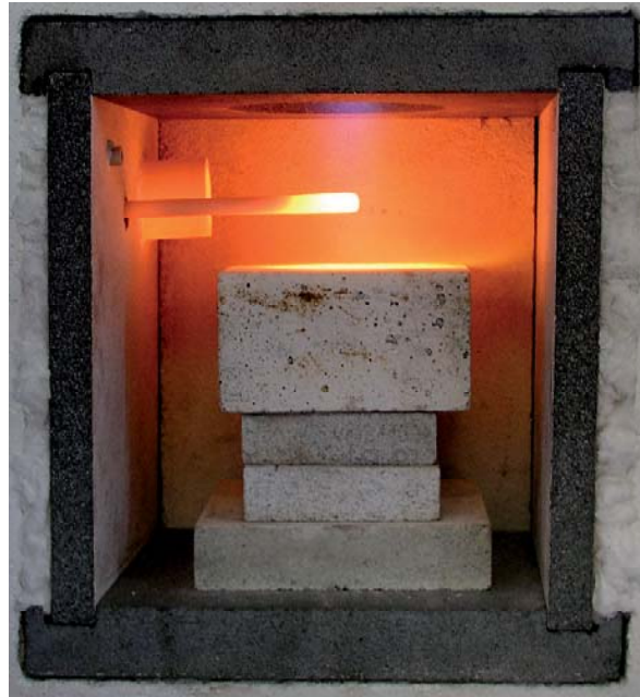
Abb. 1: Ermittlung des Strahlverschleißes bei erhöhter Temperatur.
