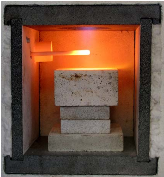
Abb. 1: Ermittlung des Strahlverschleißes bei erhöhter Temperatur.
