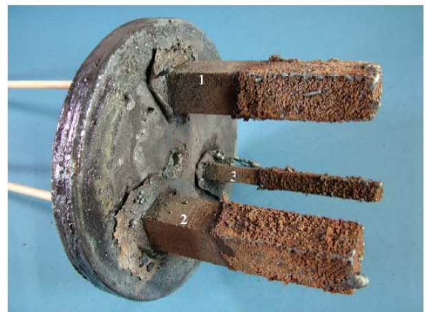
Bild 3: Tauchausgussmaterial nach 15 min Eintauchzeit bei 1600°C in eine 0,1 Gew.-% Al-desoxidierte Stahlschmelze (1 Begasung mit Luft, 2 Begasung mit Argon, 3 Referenz ohne Begasung)
